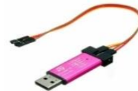
Fig. 11. STM32 ST-Link V2 mini
